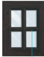
VERRIÈRE CARREAUX / MULTIPLE MULLION
